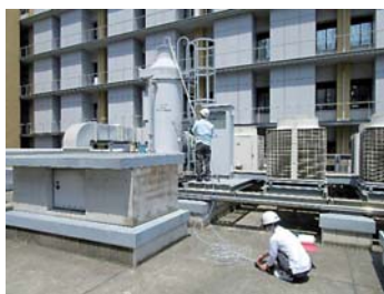
屋上に設置の排ガス処理装置出口における排ガス測定の様子
