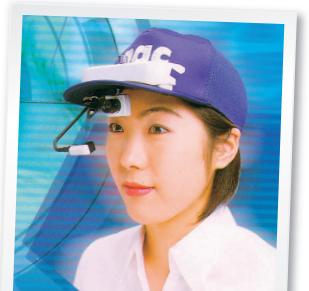
アイマークレコーダーとは・・・ ヒトが視野の中の、どこをどのくらい見ているかを測定・記録することができる装置です。
