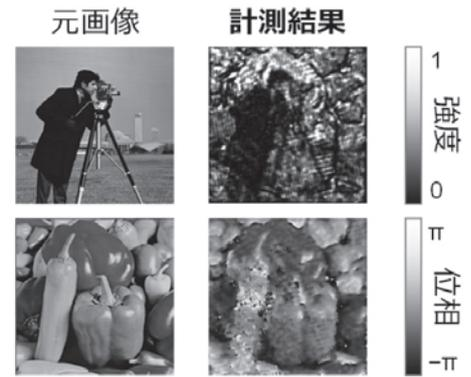
図2 計測された複素振幅分布
