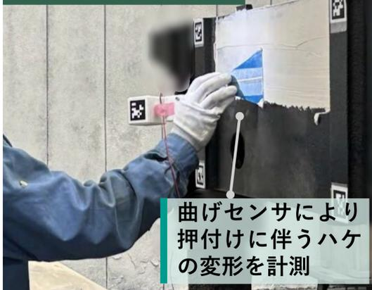
曲げセンサにより押付けに伴うハケの変形を計測
