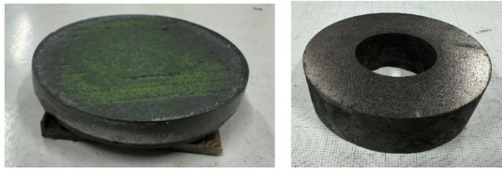
図1. 外径 80 mm の成型体から育成した YBCO 熔融凝固バルクの外観 (左: disk 形状、右: ring 形状)
