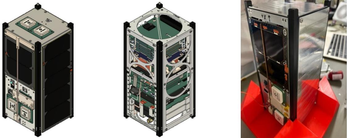
図 2 ARICA-2 の CAD (左) とエンジニアリングモデル (右)
